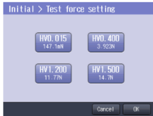
Rys. 5-61: Ekran ustawień dowolnej siły testowej
