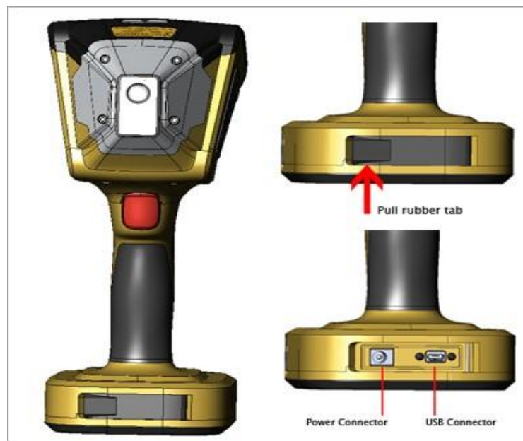
Rys. 35 Złącze USB znajduje się z przodu podstawy urządzenia
