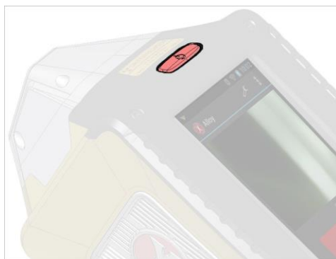
Rys. 11 Wskaźnik zasilania będzie mrgał na czerwono podczas emitowania promieniowania rentgenowskiego.
