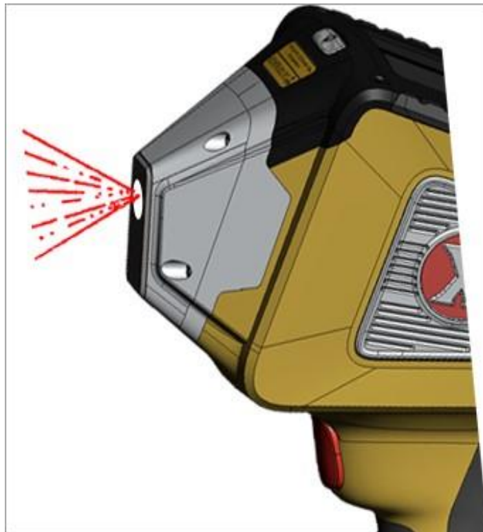
Rys. 41 Promieniowanie rentgenowskie jest emitowane wyłącznie podczas wykonywania badania
