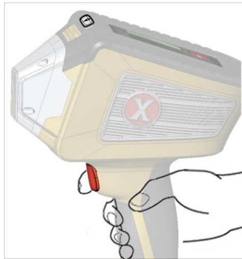
Rys. 10 Naciśnij na spust, a następnie zwolnij go - badanie nie wymaga podtrzymywania naciśniętego spustu.
