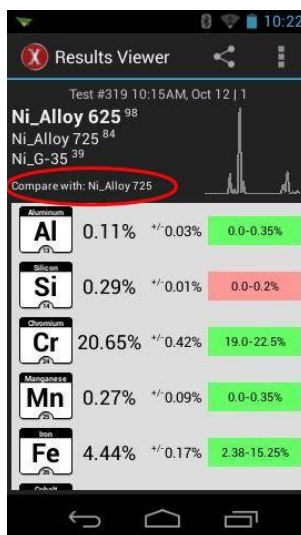
Rys. 21 Ilość wykrytego krzemu znajduje się poza zakresem dla Stopu Ni 725.
